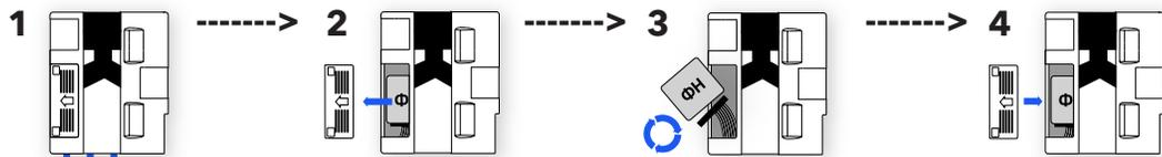
1 Для замены нужно выключить питание ККТ, отключить кабели, подключенных внешних устройств.
